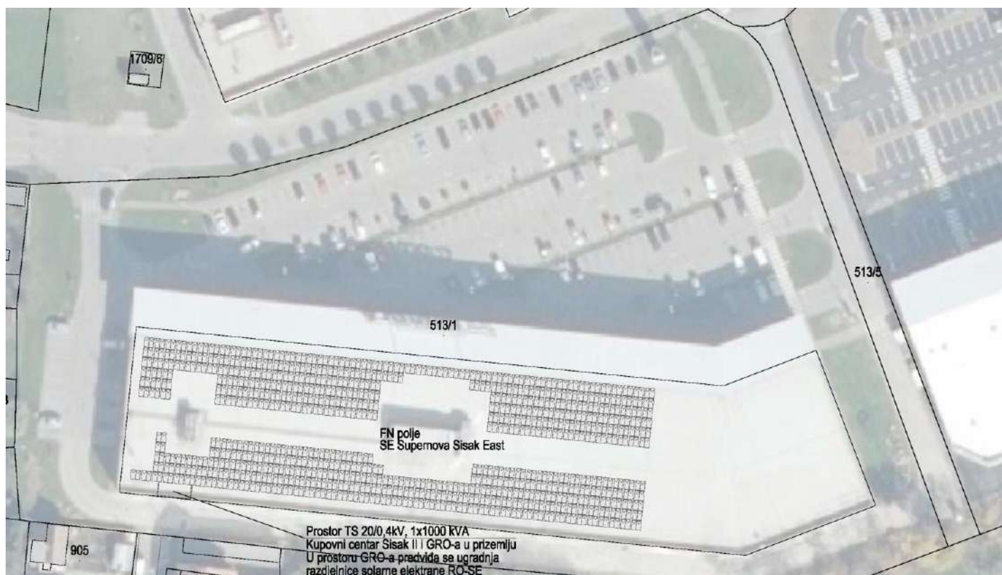
Prikaz FN panela na krovu poslovne zgrade
